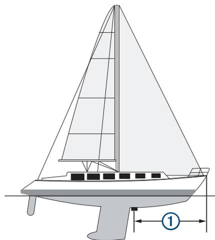
2 В поддерживаемом режиме отображения данных сонара выберите **MENU > Настройка сонара > Установка > Смещение носа судна**.
