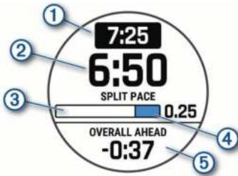
На устройстве отображается целевой темп на отрезке ①, текущий темп на отрезке ②, ход выполнения отрезка ③, расстояние до конца отрезка ④ и общее время опережения или отставания от целевого темпа ⑤.
