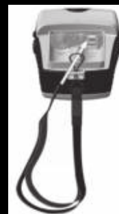
D-образное кольцо, запирающее крышку батарейного отсека
