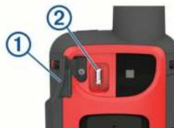
2 Подключите меньший разъем кабеля питания к порту зарядки ② на устройстве.
