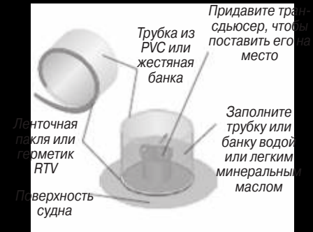
Тестирование места установки
