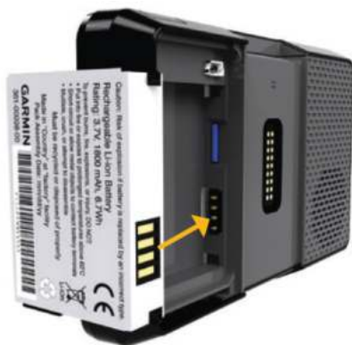
Рис.: Установка батареи.
