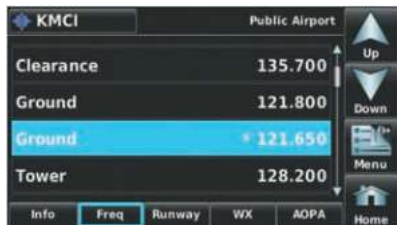
Рис.: Информация о путевой точке (вкладка "Freq" – частота).
