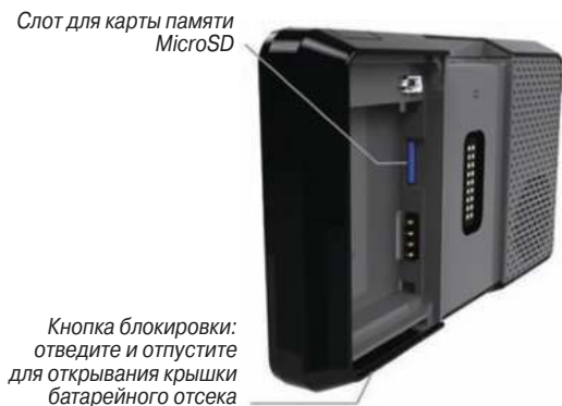
Рис.: Слот для карты памяти MicroSD в приборе аега
