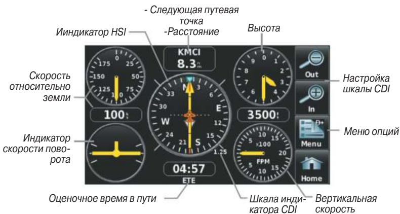
Рис.: Индикатор HSI/ приборная панель.
