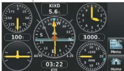
Рис.: Индикатор VNAV (приборная панель)
