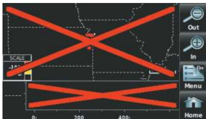
Рис.: Красный знак X на экране рельефа
