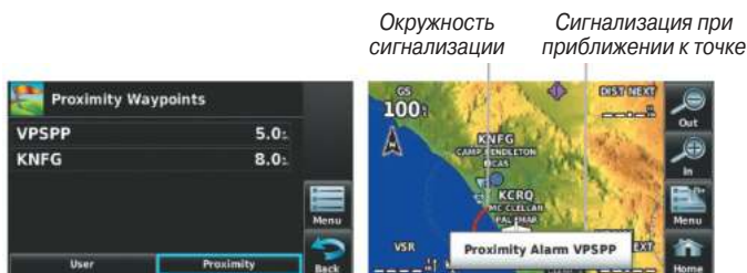
Рис.: Путевые точки с зоной сигнализации
