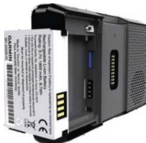
Рис.: Установка батареи.
